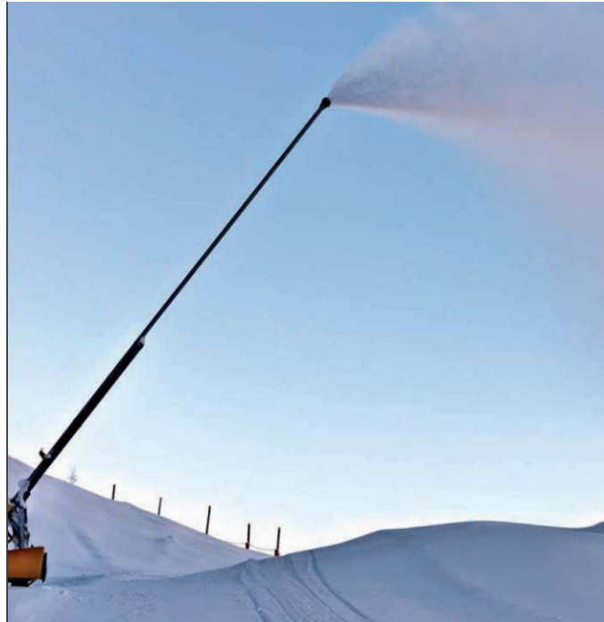
Image de la perche V3ee en cours de production de neige
