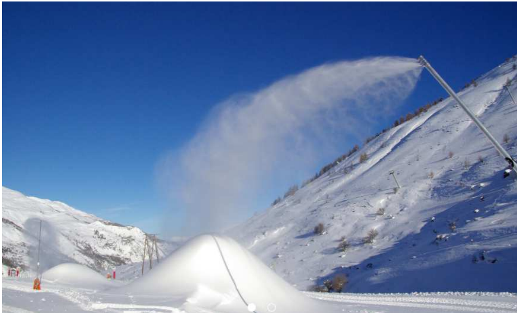
Image de la perche Rubis Evo en cours de production de neige
